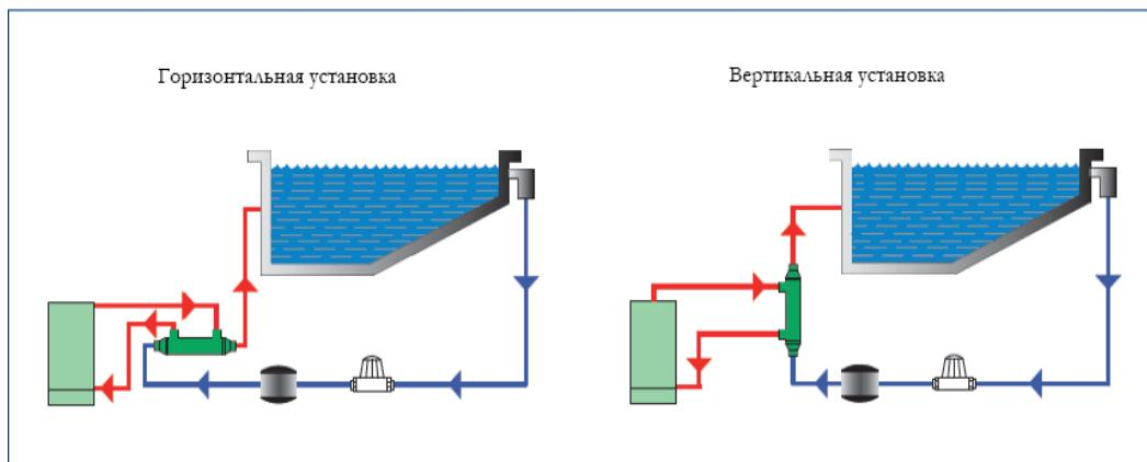
Химические вещества могут повредить теплообменник. Систему дозирования следует устанавливать в нисходящем направлении с невозвратным клапаном. При использовании химических веществ необходимо следить, чтобы в теплообменник не поступали газы во время простоя системы фильтрации.
