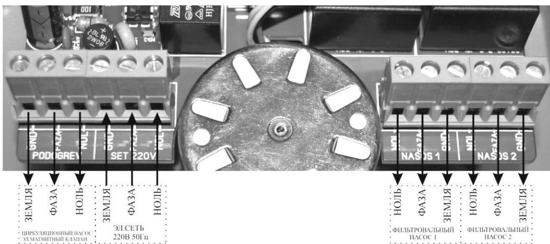
**«PODOGREV» - ЦИРКУЛЯЦИОННЫЙ НАСОС ЭЛ.МАГНИТНЫЙ КЛАПАН –**
