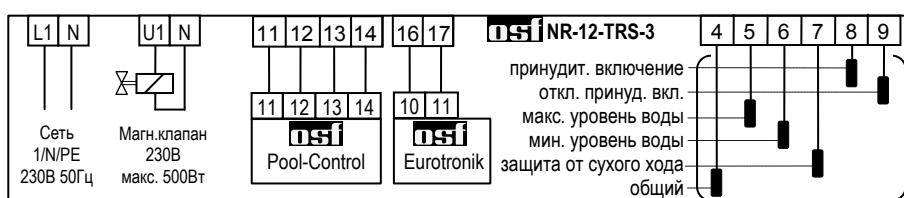
На примере показан вариант подключения с блоками управления фильтрации серии Pool-Control от компании **osil**.
