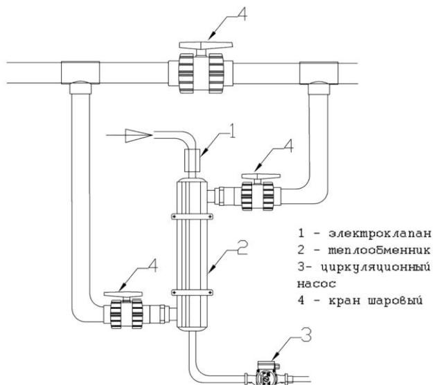
Для обвязки вторичного контура рекомендуется применять разъемные муфты с резьбовыми вставками из нержавеющей стали. Резьбовые соединения уплотнить фумлентой или герметиками.
