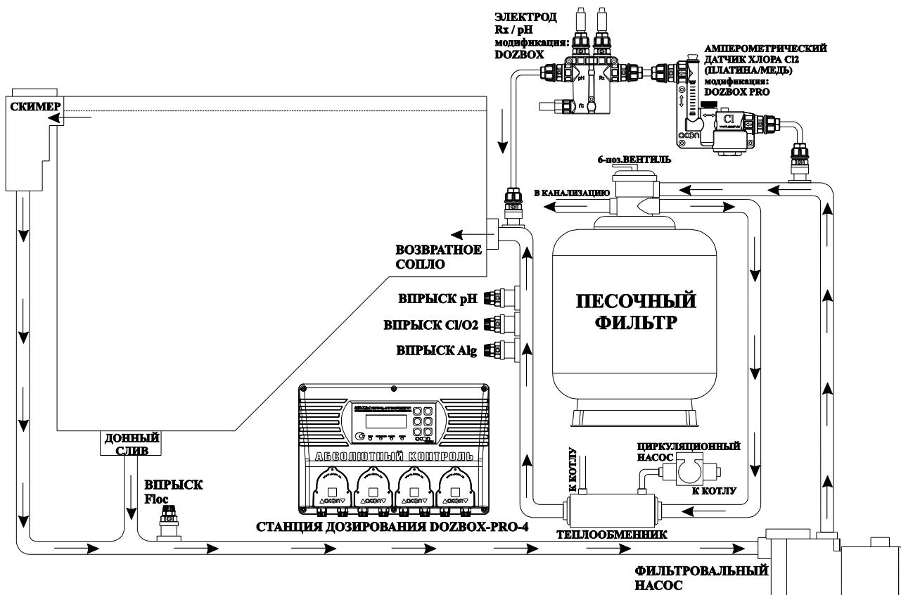
При наличии возможности, рекомендуется после измерительной ячейки, контролируемую воду не возвращать в систему, а осуществлять сброс в канализацию, на патрубке сброса установите вентиль, для контроля потока, в этом случае подключайте по схеме №2.
