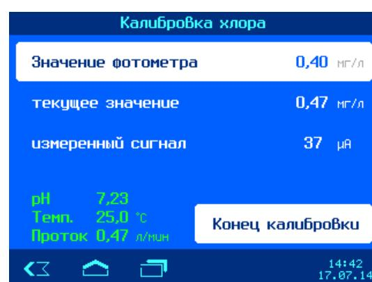
Для успешного завершения калибровки важно, чтобы вода имела установленный уровень pH, чтобы температура и проток воды через измерительную арматуру были на уровне обычного использования бассейна.
