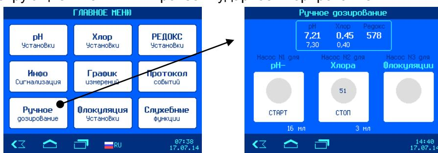
Нажатием на символ насоса можно включить и выключить соответствующий дозирующий насос. Время работы дозирующего насоса ограничено и составляет 60 секунд. Оставшееся время работы насоса отображается в центре картинки соответствующего насоса. Под насосом отображается количество прокаченного химического вещества.
