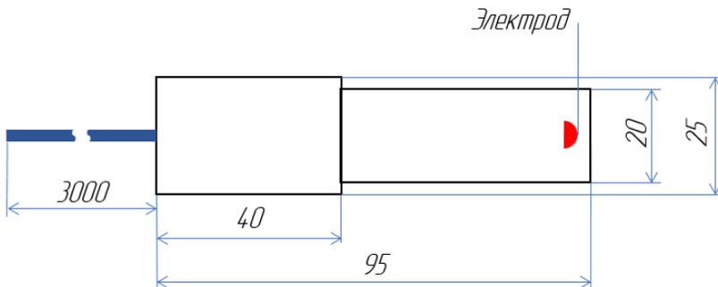
Корпус выполнен из ПВХ, электроды из нержавеющей стали марки AISI 304. Датчик устанавливается в балансном или промежуточном резервуаре, или в другом подходящем для этого месте.
