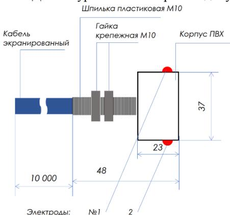
При использовании датчика ДС-1 клеммы блока управления SENSOR №1 и №2 замыкаются соединительным джампером.
