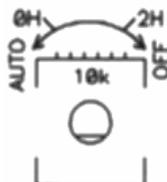
**Крайнее левое положение** (против часовой стрелки до упора, после проведенной ранее калибровки) - режим работы «по калибровке» (см. далее п. 9).
