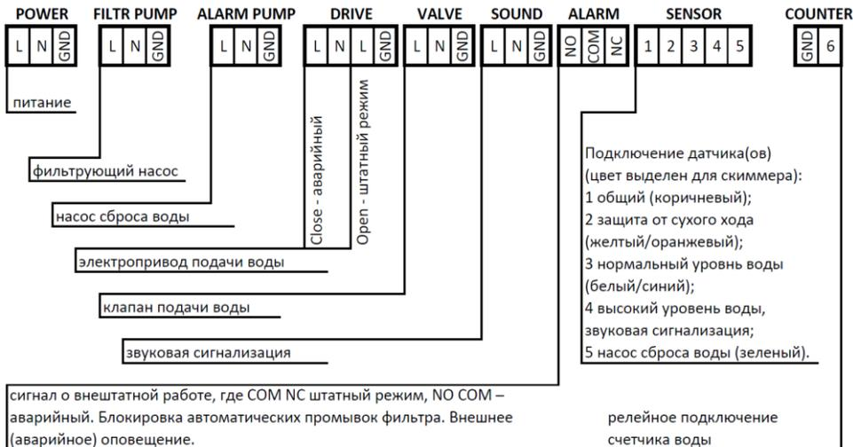
**POWER** - клемма предназначена для подключения питания блока управления и исполнительных устройств подключенных к блоку.
