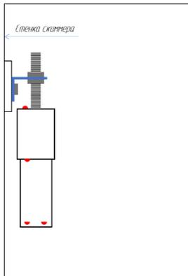
Рис. 8. Пример установки скиммерного датчика с креплением типа "шпилька"
