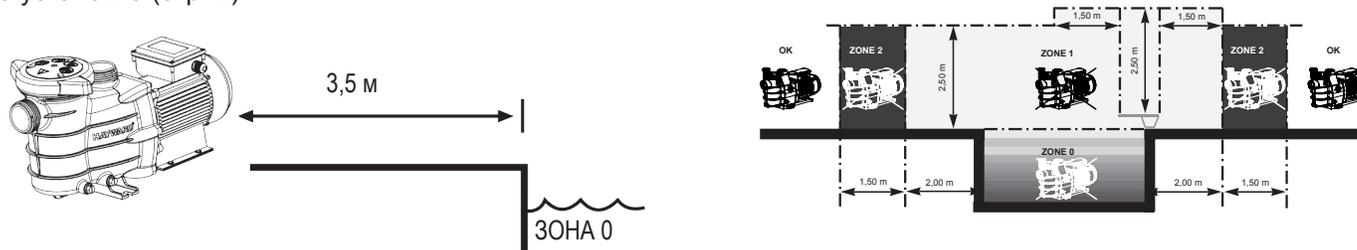
Установите насос в проветриваемом сухом месте. Необходимо обеспечить возможность свободного движения воздуха вокруг электродвигателя для создания условий естественной вентиляции.
